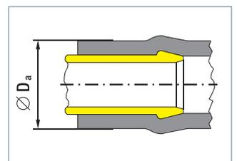
Diesem Außendurchmesser  $D_a$  wird dann der entsprechende Nenndurchmesser  $d_1$  zugeordnet.
