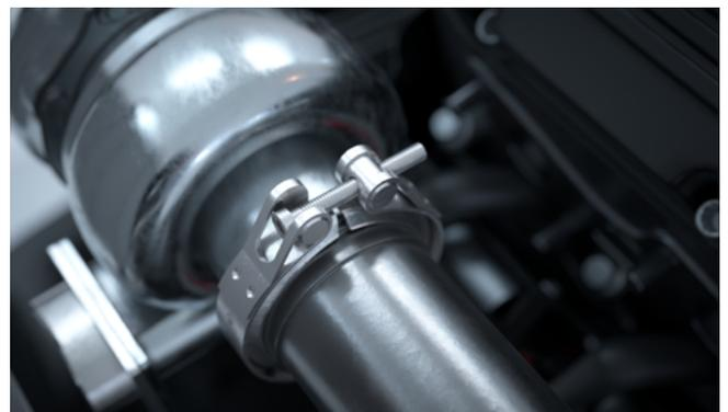
Le **V-Clamp** sono ideali per applicazioni in cui la temperatura dei gas di scarico può raggiungere fino ai 650 °C, come ad esempio nei motori Diesel o nei veicoli pesanti.
