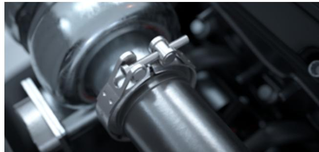
As **abraçadeiras em V** são ideais para aplicações em que a faixa de temperatura dos gases de escape é de até 650 °C — por exemplo, em motores diesel e veículos pesados.
