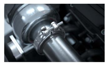
**V-Band-Schellen** eignen sich ideal für Anwendungen mit einem Abgastemperaturbereich von bis zu 650 °C – beispielsweise bei Dieselmotoren und Nutzfahrzeugen.
